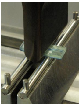
◀ Abb.3: Short-Beam-Test zur Untersuchung des Verbundverhaltens
